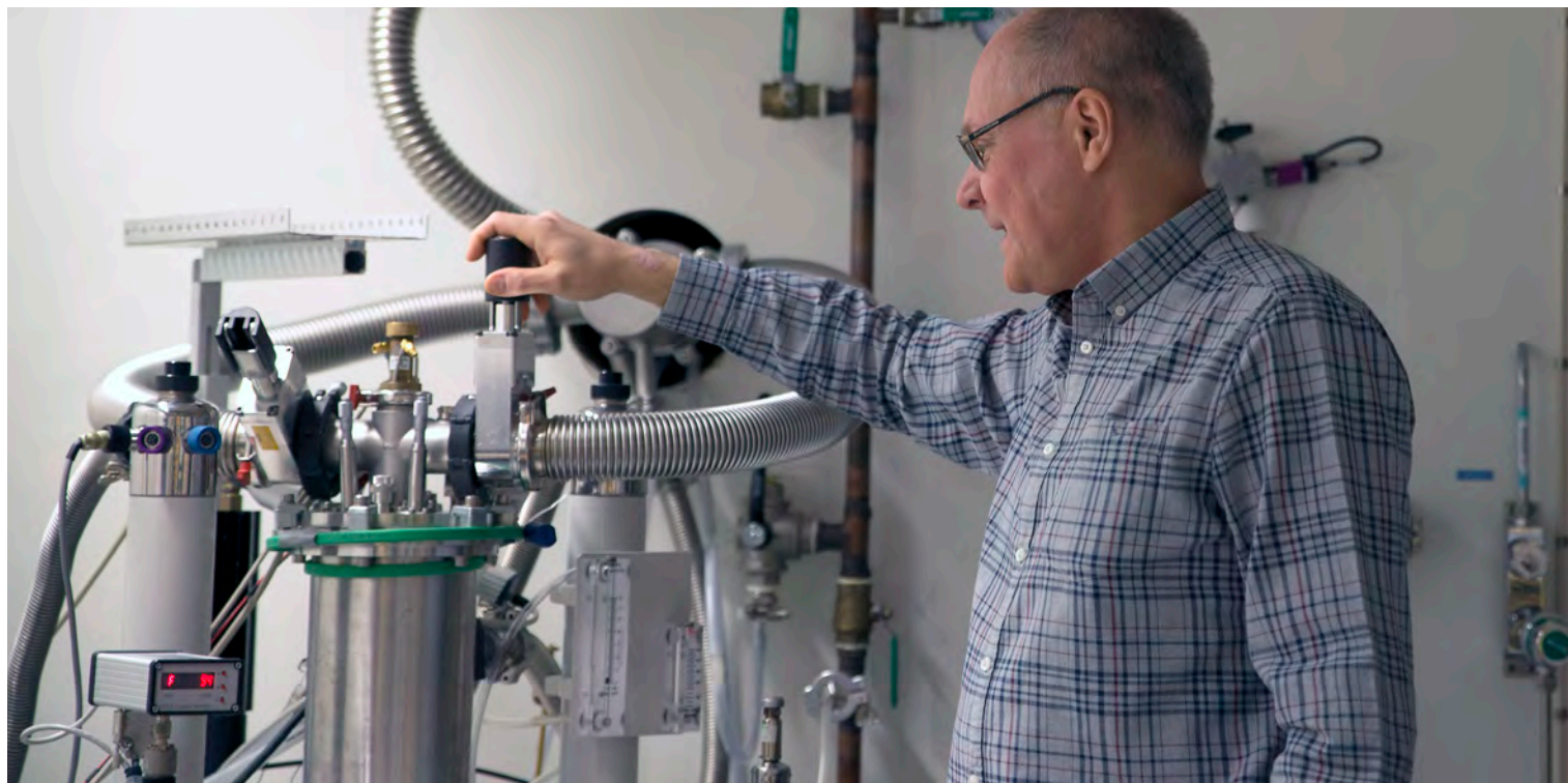
Biomarkören kyls ner till minus 272 grader. Detta för att atomkärnorna ska kunna hyperpolariseras innan de injiceras inför HP-MR-undersökningen.
